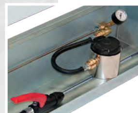
• Prüfung eines Sicherheitsventils mit einem Ventilprüfkopf.
