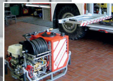
• Das HLG POWERJET zum Löschen von PKW-Bränden, Klein- und Entstehungsbränden!
