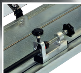
• Prüfung eines Dauerdruck-Feuerlöserschlauches, der mit dem in Längsrichtung beweglichen Düsenverschluß des SPGV verschlossen ist.
