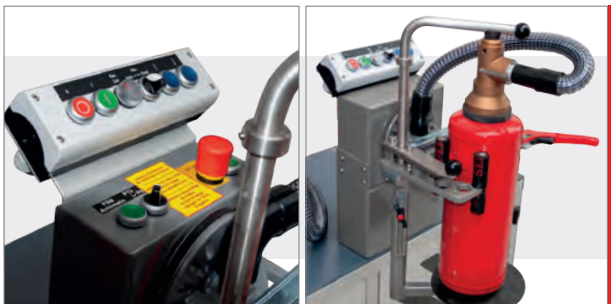
• Zeitsteuerung der Reversierung und elektrische Höhenverstellung.
