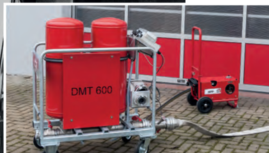
• Durchflussmessgerät DMT 600 im Einsatz.
